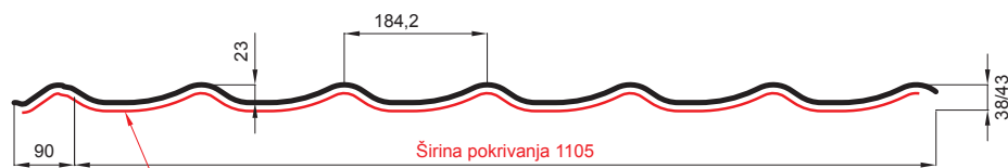
L – OPTIMALNA DUŽINA POKRIVAČA ZA MODUL 350 mm
